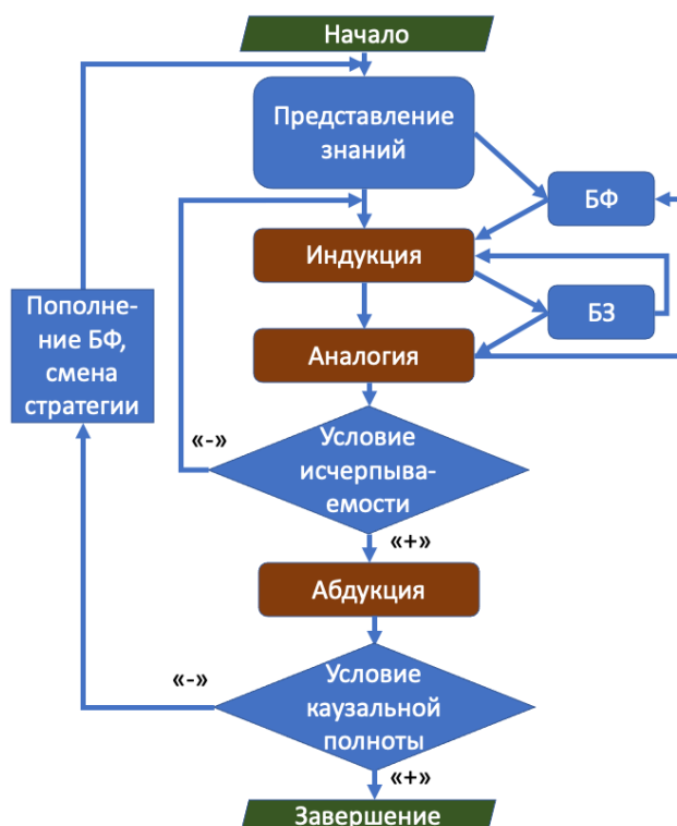
Рисунок 3 - Процедурная блок-схема ДСМ-метода АПИ
